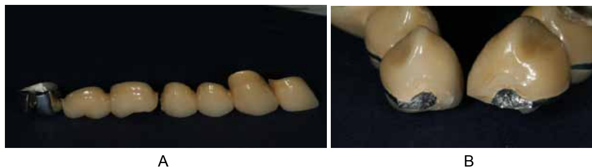
Slika 3. A – zlom dolgega kovinskoporcelanskega stranskega mostu na sredini med členi. B – lomna površina, ki je poddimenzionirana in zato se je most zlomil, kljub kovinskim ojačitvam na palatinalni strani členov.
